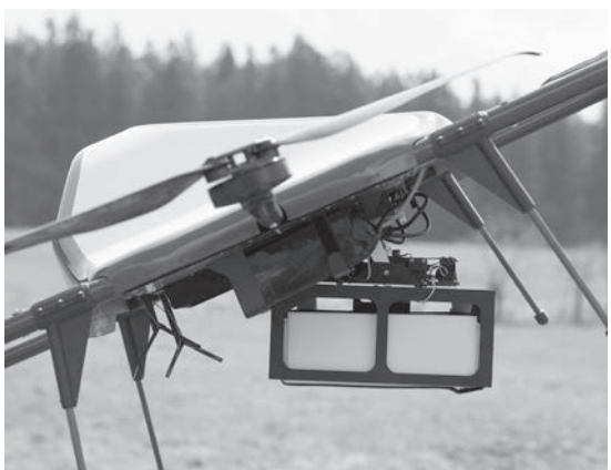
ドローン配送サービス化に向け動きを加速させているANAホールディングスと共同開発した物流ドローン量産試作機「Next DELIVERY Ver.2」。2022年度内に、離島山間部でのドローン配送サービスの実施を目指す。
