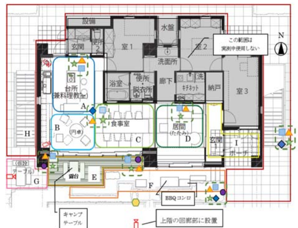
図3 対象住戸平面図およびゾーニング、実測機器設置箇所
