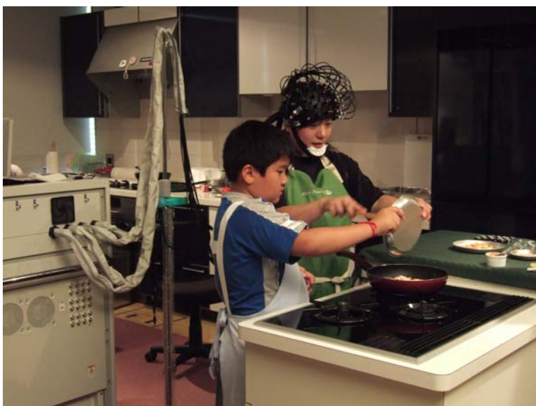
図 2 近赤外線計測装置による脳活動の計測 頭部にプローブを装着し、親子でタマネギを炒めるタスク中の被験者親子
