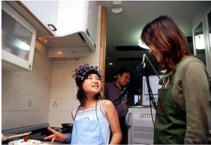
図 11 近赤外線計測装置による計測 被験者の子どもの頭部にプローブを装着し、二つの調理タスクを行った。
