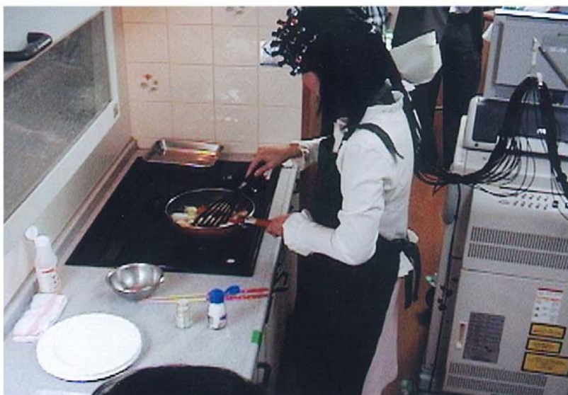
図3 近赤外線計測装置による脳活動の計測 「ガスコンロで炒める」調理タスク中の被験者
