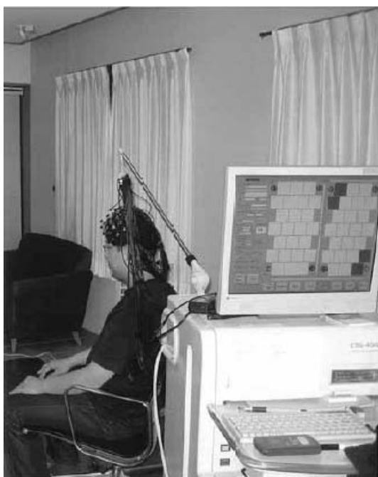
図1 近赤外線計測装置とプローブ装着の様子
