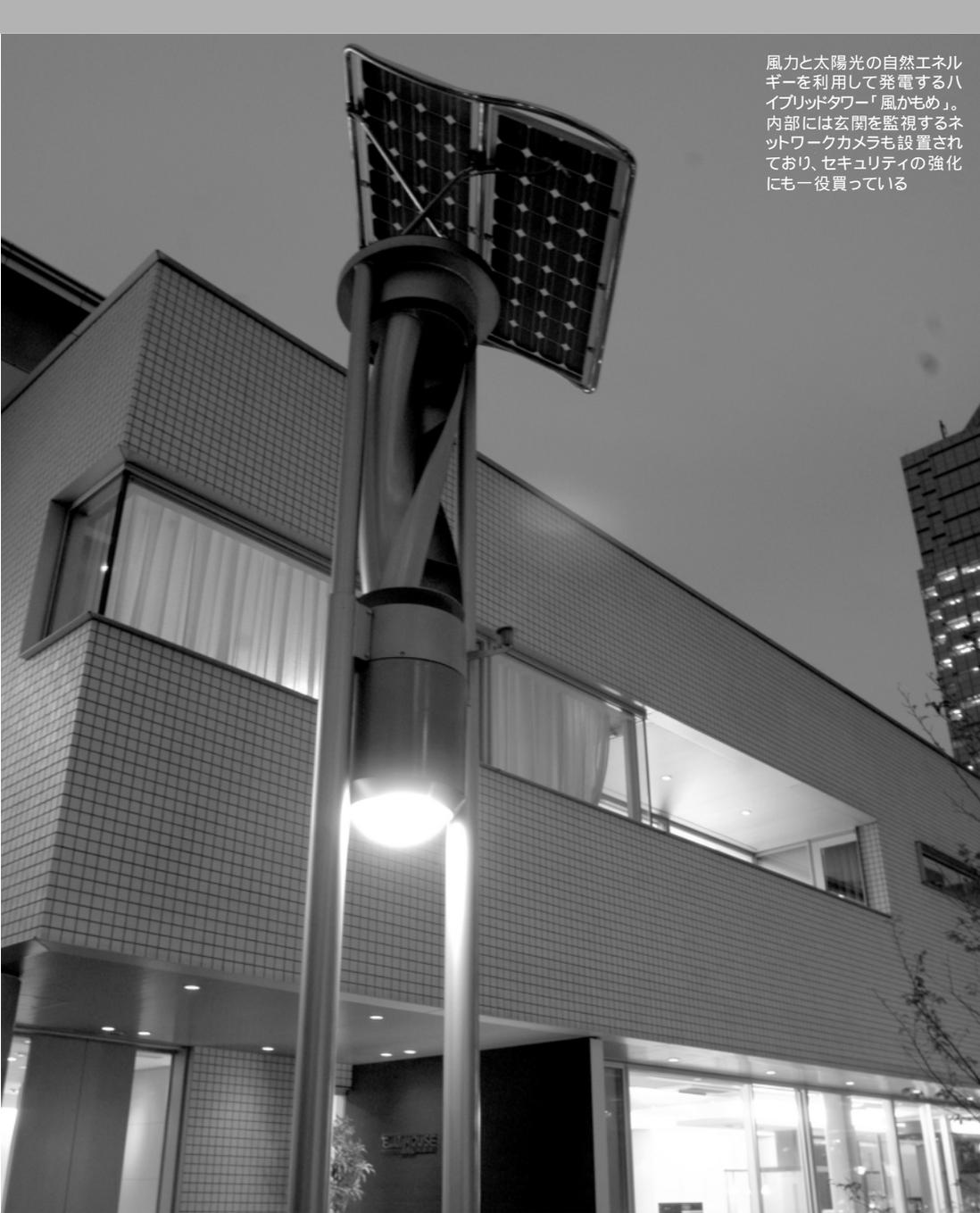
風力と太陽光の自然エネルギーを利用して発電するハイブリッドタワー「風かもめ」。内部には玄関を監視するネットワークカメラも設置されており、セキュリティの強化にも一役買っている
