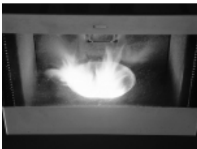
ペレットストーブの燃焼部。燃焼効率が良いので燃えかすなどはほとんど残らない
