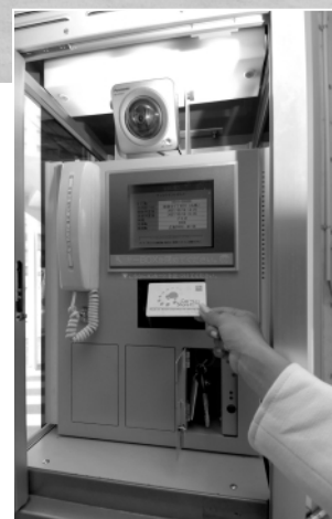
駐車場横にある予約用のタワー。会員は、自動車の利用時間をパソコンや携帯電話で予約する。後は基本的にタワーによる無人対応で自動車が利用できる
