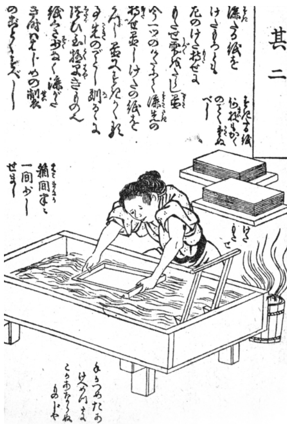
紙漉し。水に溶いた紙料(原料)を漉き簾に吸んで一枚ずつ漉き上げる(『紙漉し重宝記』より)
