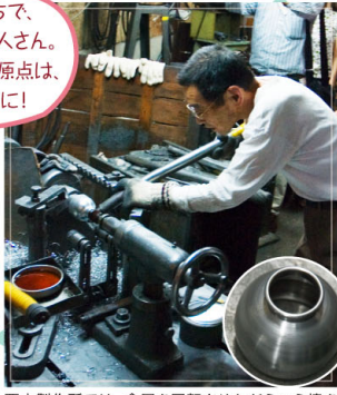
西山製作所では、金属を回転させながらへら棒 を押し当てて少しずつ変形させる「へら絞り」の加工 法で、金枠などを次々と注文の形に仕上げている
