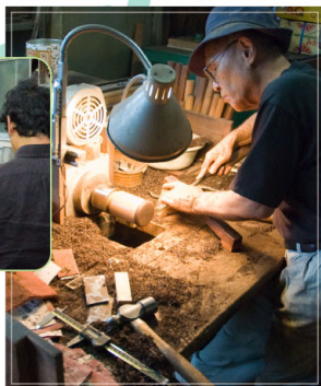
仏壇・仏具などの木製品を製作する田中木工所。 回転する用材に刃を当てて削り出す「挽き物」の 技術は、まさに熟練の技そのもの
