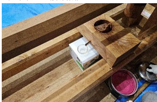
図5. エゴマ油の搾油実践風景:搾油機組立、圧搾(撮影:筆者)
