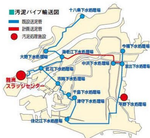
図8. 大阪市の汚泥パイプ輸送図(大阪市『おおさかエコキッズ 下水道を学ぼう！』)
