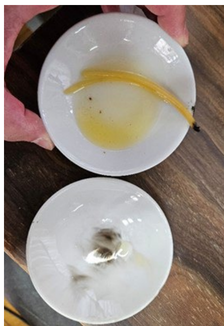
図6. 油売りの再現とエゴマ油の燃焼実験: 商人の実演、燃焼の様子、灯芯と煤
