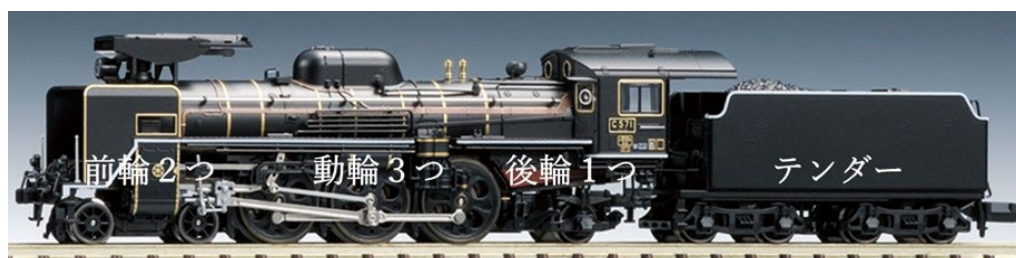
図 15. C57 形蒸気機関車：2C1テンダー（TOMIX ※9 ）に筆者加筆
