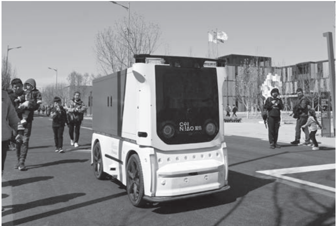
中国・河北省の雄安新区を走る無人配達車。周囲の環境を感知して歩行人や車などの障害物を避けながら、集配ステーションからスマート宅配ボックスまで小包を配達する。画像提供／新華社／共同通信イメージズ
