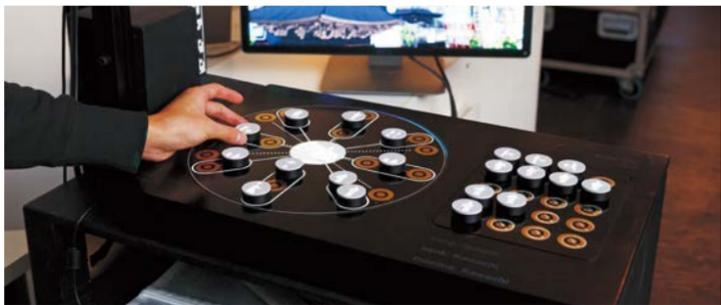
独自に開発したオーディオビジュアルデバイス「Quasar (クエーザー)」は、キャップ状の装置一つひとつに、たとえば太鼓の音色と盆踊りをする踊り手の映像が組み込まれている。この色々な種類のキャップを、円形のテーブル上に自在に配置し読み込ませると、PC上や連動するスクリーンに、その複数のリズムと踊り手の映像が絶妙にマッチングし映し出される。
