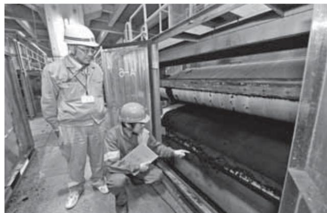
ベルトプレス型汚泥脱水機。汚泥に含まれる水分を取り除き、固形の脱水汚泥にする(上図)
