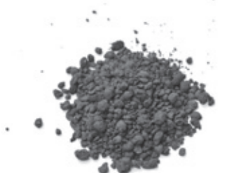
乾燥汚泥。重さはもとの5分の1(体積は4分の1)になり、セメント工場などに運ばれセメント原料として使われる(上図③)
