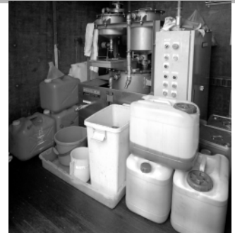
大学内の食堂裏に設けられた製油プラント。JRのコンテナを再利用し、製油の機械も廃棄されるものを探して手に入れたという、環境に配慮したハンドメイドのプラントだ
