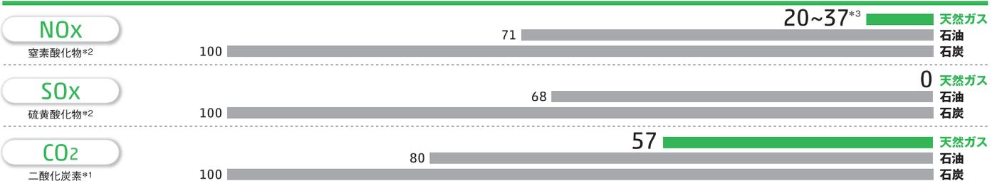
3種の化石燃料の燃焼生成物発生量を比較した結果。石炭の場合を100として、石油、天然ガスと比較した。
