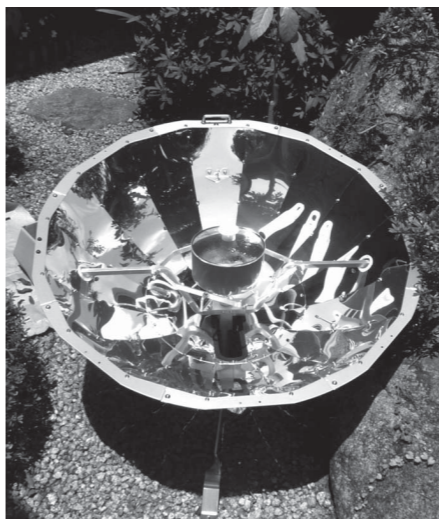
【写真3】太陽熱調理器(ソーラークッカー)
